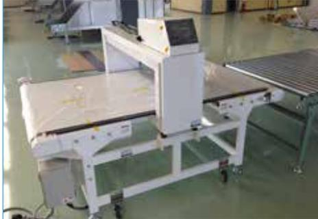
各ラインの生産した品物を、金属検出器に通して異物混入の確認をしています。安心した製品をお客様へ提供できるように努めています。
