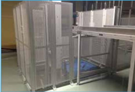
人が立ち入ると危険な箇所には、安全柵を設置して未然に事故防止をしています。人が入る際は、機械動作を停止し安全に作業できるようにしています。従業員の働きやすい環境作りに努めています。
