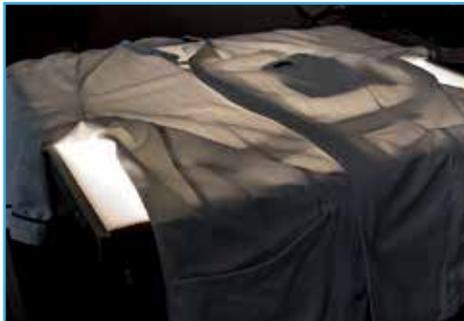
入荷した品物を光を用いてポケットチェックをし、異物混入の確認をしています。洗濯工程前で異物混入を防ぐことで、お客様へ安心した品物を提供できるように努めています。
