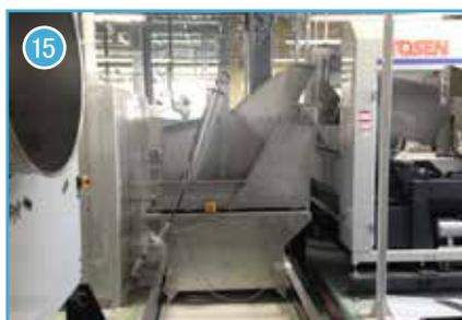
連続洗濯機から出る品物を、シーツ類・タオル類は高圧脱水機、ボタン付きの衣類などの品物は遠心脱水機へ搬送するコンベアです。
