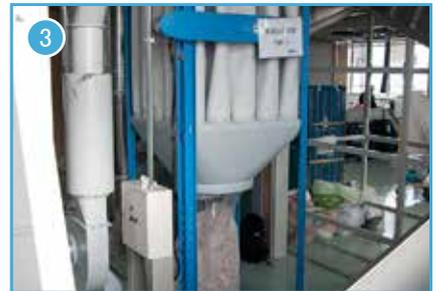
乾燥機から出る塵を自動的に集塵する装置です。自動的に除去するため、乾燥時間が保たれるので生産性向上します。また、工場外に塵を出さないよう努力を行っています。
