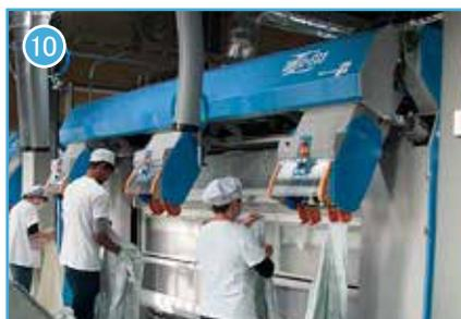
デュベを1点1点ロールアイロナーに送り込む機械です。投入作業は3人で行い、投入フックに掛けて品物を送り込みます。しわを効率良く伸ばして、高品質の品物に仕上がっています。
