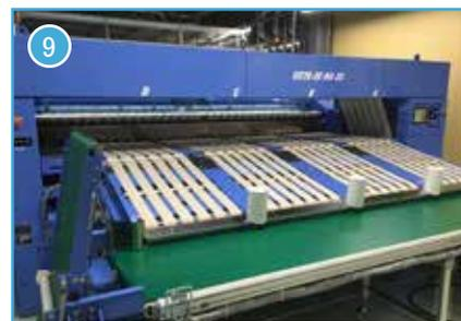
ロール機より流れてくる品物を、設定された長さに合わせて折り畳む機械です。ナイフ機構で、正確でシャープに折り畳みます。検査カメラを搭載し、破れ・汚れ・シミ等を検査しています。
