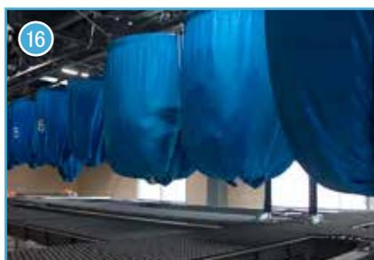
汚れている品物を、リネンバッグでストック＆投入するシステムです。オランダのウィルゲン社より輸入しています。レール形状がカーテンレール構造のため、ほこりの溜まりにくい機構です。
