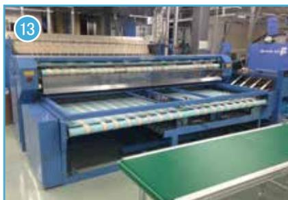
ロール機より流れてくる品物を、設定された長さに合わせて折り畳む機械です。ナイフ機構で、正確でシャープに折り畳みます。
