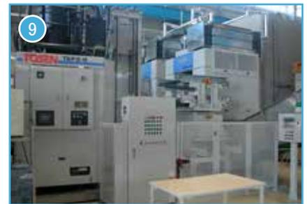
TOSEN 山梨工場製のコンベアシステムです。品物を搬送する為に使用しています。搬送の制御もTOSEN製で施工しています。
