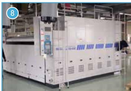
投入機より流れてくる品物をロールに当てて乾燥・仕上する機械です。仕上がった品物は自動でたたみ機に流れます。省エネ・静音性に優れた機械です。
