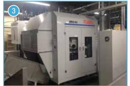
プレス処理できない品物を遠心脱水する機械です。病衣・私物のボタン類を破損しない機構です。病衣・私物類の脱水を行います。
