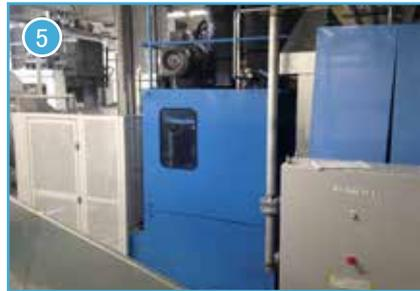
連続洗濯機で洗濯が終わった品物を高圧脱水する機械です。脱水後は、乾燥機へ自動搬送/投入します。
