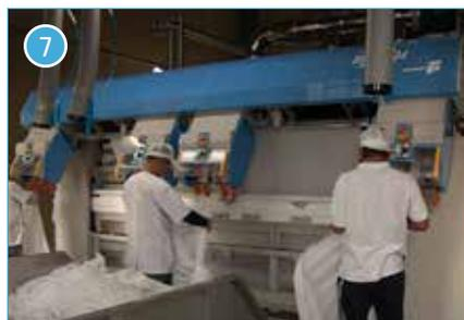
シーツを1点1点ロールアイロナーに送り込む機械です。投入作業は4人で行い、投入フックに掛けて品物を送り込みます。しわを効率良く伸ばして、高品質の品物に仕上がっています。
