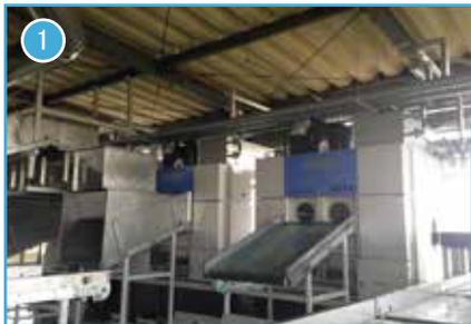
脱水機より搬送されたシャツ・デューペ・ピロを乾燥・シェーキングする機械です。品物の絡みをほぐすため、仕上作業への負担を軽減します。品物は、1Fのロール仕上エリアまで自動搬送します。
